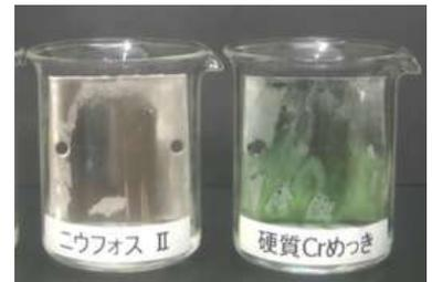
塩素ガスによる耐薬品性試験結果
